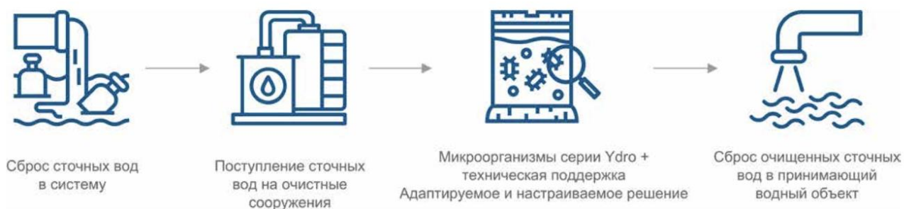
Рис. 2. Схема применения технологии «БИО-ГРИН-ЛАЙТ» на очистных сооружениях
